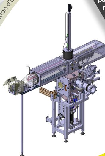
Cible solide tournante pour la production d'astate. Vue C4O.
